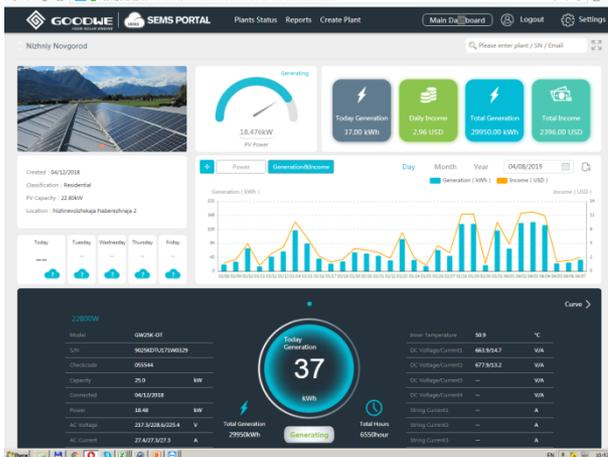
Солнечный контроллер-инвертор позволяет осуществлять мониторинг параметров работы электростанции дистанционно через интернет.
